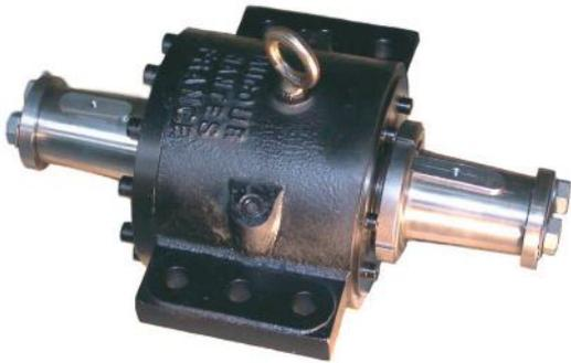
De conception et de fabrication MAUCOUR, ce type de palier butée résiste à de fortes poussées axiales. Il comporte un roulement porteur pour supporter les charges radiales ainsi qu'un roulement butée pour encaisser les charges axiales. Il est possible de monter un accouplement souple sur l'avant, entre le palier et le tourteau de l'inverseur.
