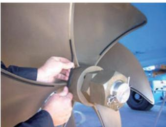
La rainure brevetée en «queue d'aronde» est réalisée grâce à une machine à commandes numériques 5 axes. Les nouvelles bandes sont coupées à la longueur et insérées. Elles sont durables et bon marché.
