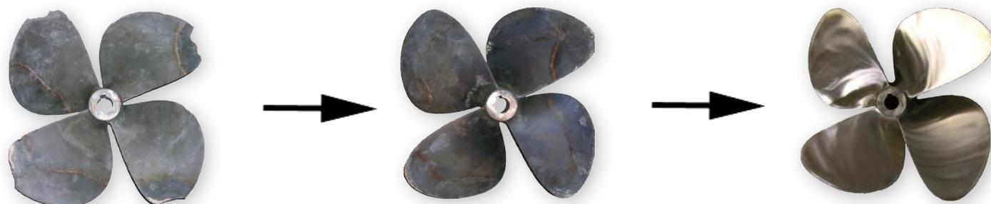
Pour vos hélices endommagées ou ayant besoin de modifications éventuelles, nous sommes en mesure de les réparer et modifier pour limiter les coûts par rapport au rachat d'une hélice de remplacement neuve et surtout réduire au maximum le temps d'immobilisation du bateau.
