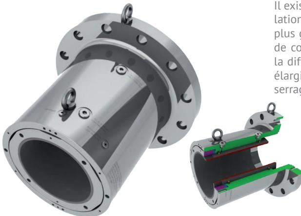
Il existe une variété d'accouplements OHSM conçus pour les installations avec hélices à pas variable et d'autres installations où une plus grande distance entre les arbres est nécessaire. Dans ce type de couplage, le moyeu d'accouplement est également bridé mais la différence par rapport aux accouplements OHSM est un moyeu élargi de façon à ce que la bride ait une plus grande longueur de serrage.
