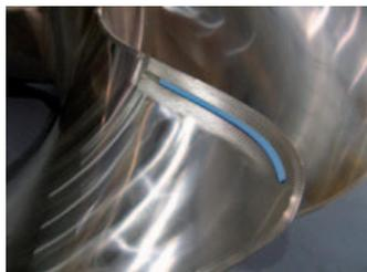
Un point d'entrée spécialement conçu est prévu à une extrémité de la rainure pour faciliter l'installation de la bande Interceptor™.
