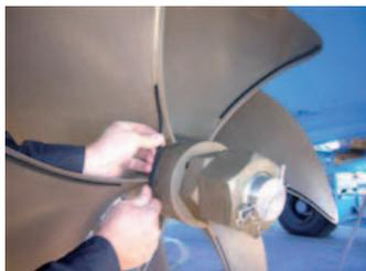
La rainure brevetée en «queue d'aronde» est réalisée grâce à une machine à commandes numériques 5 axes. Les nouvelles bandes sont coupées à la longueur et insérées. Elles sont durables et bon marché.
