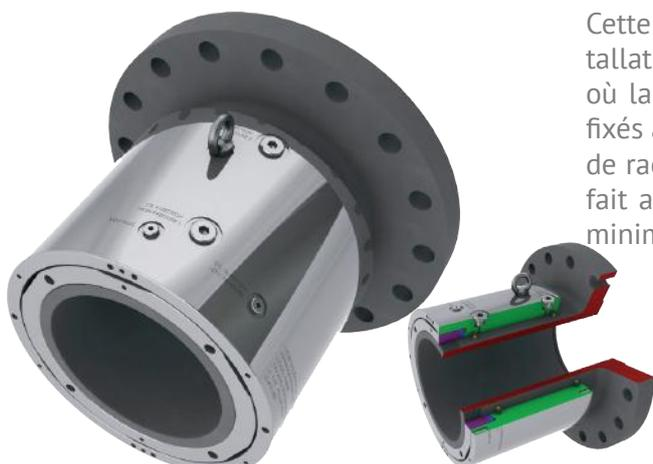
Cette version d'accouplement a été développée pour les installations avec obligation de transmission de couple moyen où la position de l'arbre ne peut pas être ajustée. Ils sont fixés à la bride qui est intégrée dans le manchon de la bride de raccordement avant le couplage. De cette façon, un parfait alignement entre des brides peut être réalisé avec un minimum d'effort.
